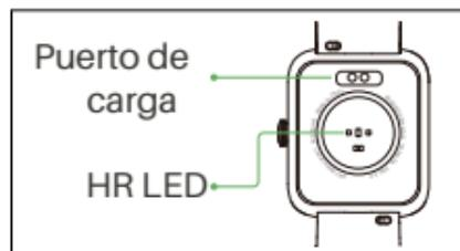
**Nota:** La separación entre pines del puerto de carga es de 2.8mm.
